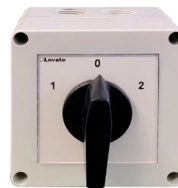
Manueller Umschalter (MTS) 1, 0, 2 (NETZ / 0 / GENERATOR).
