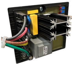
Genauigkeit Automatischer Spannungsregler (AVR) +-1%.
