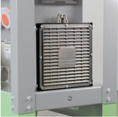
IP44-Filtersatz für Lichtmaschine (Ansaug- und Ausblasfilter) mit austauschbarem Filterelement.
