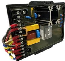
Genauigkeit Automatischer Spannungsregler mit dreiphasiger Messung (AVR) +-1%.
